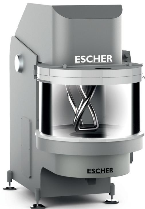
Knetmaschine mit System für die Austragung über den Kesselboden. Der Teig wird auf ein Förderband oder einen verfahrbaren Kessel ausgetragen. Das Knetsystem kann mit einer Spirale (MD-Line) oder einem Doppelwerkzeug (MDW-Line) ausgeführt sein.
